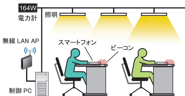
図 1 ビーコン型知的照明システムの構成図
