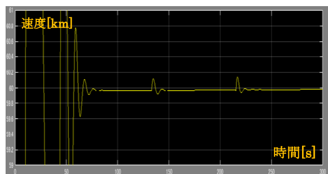
図9 PID制御の結果 (外乱あり, Ki=5, Kd=1 のとき)
