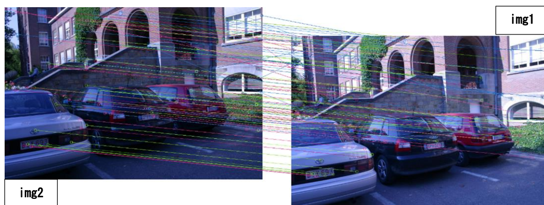
図 9 コントラスト差の小さい画像ペアにおける SIFT の対応点
