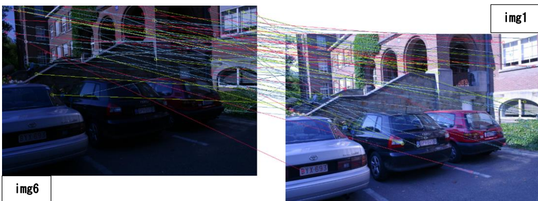
図 11 コントラスト差の大きい画像ペアにおける SIFT の対応点
