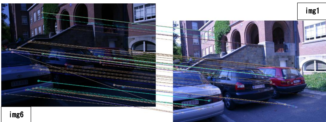
図 12 コントラスト差の大きい画像ペアにおける提案手法の対応点
