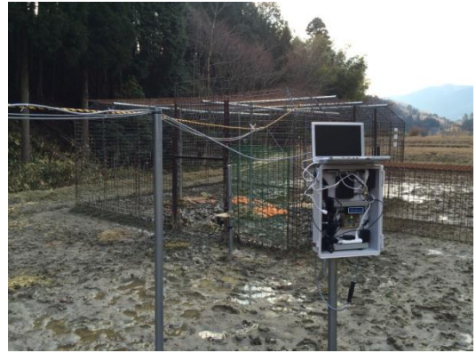
図 9 罠と監視システム (PC・Kinect は箱に格納)
