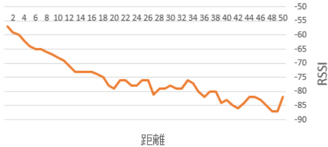
図 5: ビーコン 1 個の場合の測定結果
