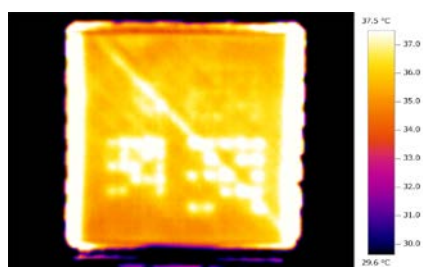
図4 密度100%の造形物の表面温度分布画像。
