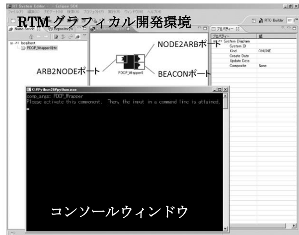
図 4 PDCP-Wrapper-RTC 動作画面 (手前が PDCP-Wrapper-RTC のコマンドライン。後ろが RTM グラフィカル開発環境上で見た PDCP-Wrapper-RTC)
