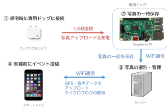
図 5 システム構成図
