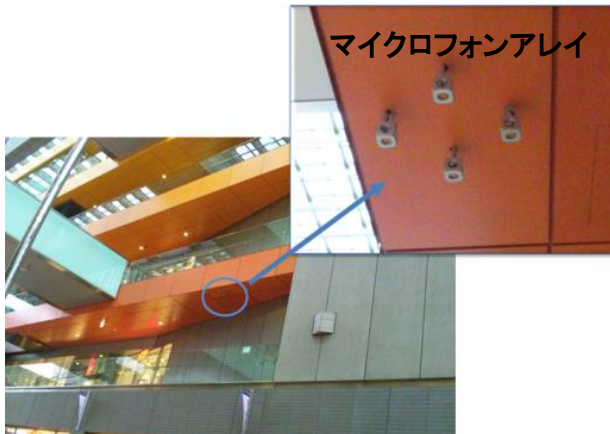
図3 マイクロフォンアレイを設置した環境計測場所の例 (場所: 二子玉川ライズショッピングセンター)
