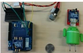
図1. 作成したボード及び XBee (S2B)
