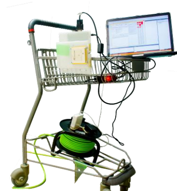
図3 製作したショッピングカート
