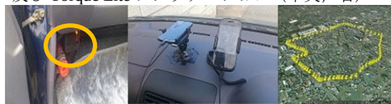
図 2 ELM327 装着場所 (左), センシング環境 (中央) 及び実験走行経路 (右)
