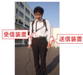
図3 送受信装置の取付け位置
