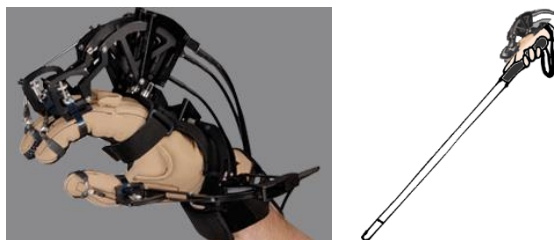
図2. 手指全体の触力覚装置
