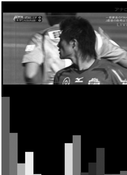
図3 フレーム画像（上）と色ヒストグラムの計算結果（下）
