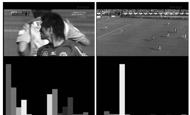
図4 1秒間隔の2枚のフレーム画像（上）とその色ヒストグラムの計算結果（下）
