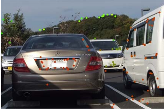
図3 ステレオ画像の対応点分布例(距離 5.0m, 左画像)
