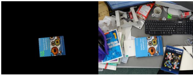
図 7 : H_2 で射影変換された入力画像と、参照画像
