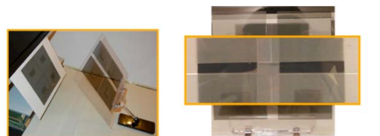
2 枚の偏光板の配置 頭部位置が上にずれた場合の見え方
