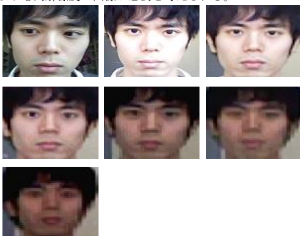
図 1-1~7: 左から、Web カメラから水平距離 0.2m, 0.5m, 1.0m, 1.5m, 2.0m, 2.5m, 3.0m 離れた位置での顔認識処理結果。3.0m 以上離れると認識が出来ない。
