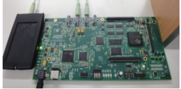
図 2: DSP ボード実装時
