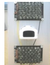
図3 Wiiリモコンと赤外線投光器の設置
