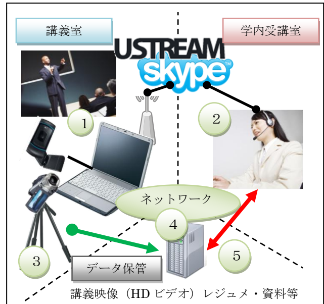
図1 Skype/Ustreamによる遠隔講義の構成図
