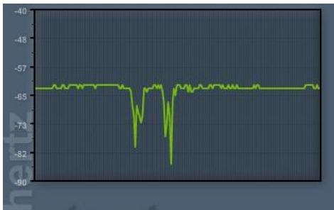
図5 エンドデバイス1（扉に設置したデバイス）の電波強度の計測例，入退室時
