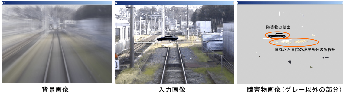
図4 背景(軌道面)輝度の平均値&分散検定による障害物検出結果
