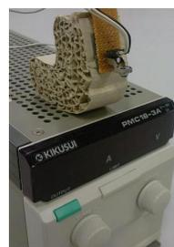
図 4: 使用する赤外線センサ 図 5: 機器へのセンサ取付例
