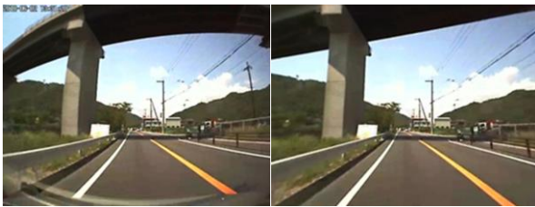
(a) 撮影画像 (b) 歪み補正画像 図2 カメラキャリブレーションによる歪み補正
