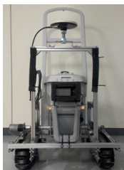
図1 白線引きロボットカー
