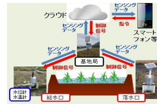
ほ場水管理システム
