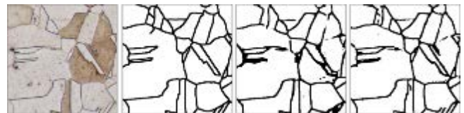
①入力画像 ②教師画像 ③SegNet出力画像 ④U-Net出力画像
