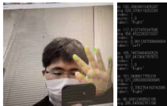
図1、マウスカーソルの動作の様子とランドマークによる指との間の距離の計測結果
