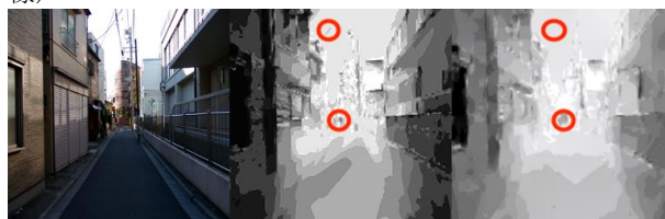
図3. 左側はRGBカラー画像,中央はライトフィールドカメラによる深度画像(正解画像),pix2pixによる深度画像(提案方法による推定画像)
