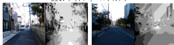
図2. ライトフィールドカメラで撮影した学習データ(300データセットの2セット;右側は深度画像,左側はRGBカラー画像)
