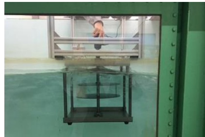
図 1. マイクロ水力発電システム(1 段構造の例)
