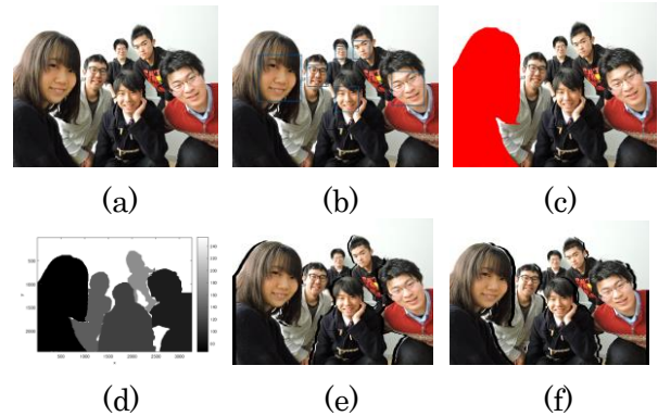
図1. (a)原画像, (b)顔認識, (c)領域分割, (d)深度画像, (e)左眼画像, (f)右眼画像
