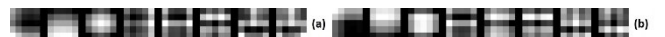
図 3 Improved PLSNet により学習された二層目のフィルタ(a, b: 一成分目, 二成分目)
