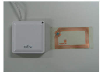
図 6. RFIDリーダとタグ
