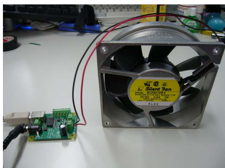
図1 直流ファンを用いた送風ディスプレイ Fig. 1 Prototype of blow display with DC fan.
