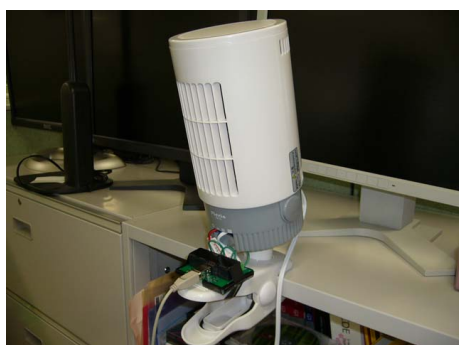
図2 扇風機を改造した送風ディスプレイ Fig. 2 Another prototype with table fan.
