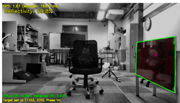
図 16 反射面の投影領域の特定イメージ（画面右端）
