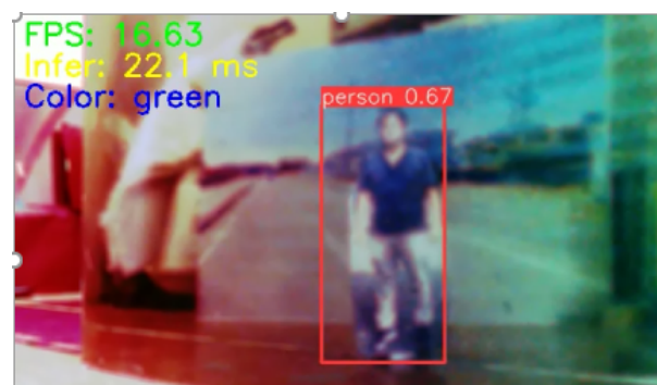
図 19 塗装反射面に映り込む人物検出結果
