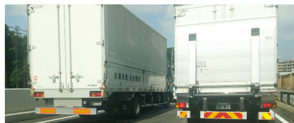
図 3 隣接車線を走行する他車両側面（図中左側車両）に映り込む見通し外車両
