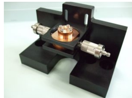
写真 1 遮断円筒導波管法用の測定治具（川島製作所製） （36, 50, 60, 80, 100 GHz 各空洞共振器を備えている）
