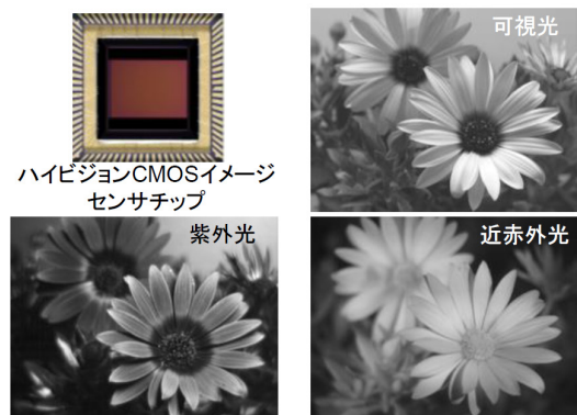
図2 開発した広光波長帯域 CMOS イメージセンサチップと本チップを用いて紫外・可視・近赤外光照射下で取得したオステオスペルマムの撮像例。
