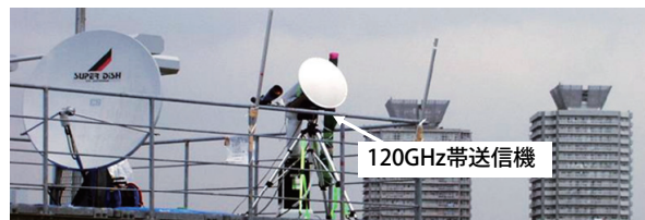
図3. 120GHz 帯無線の屋外実験の様子
