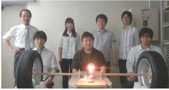
図 2 : 高周波伝送効率 80% で 60W 電球への無線給電に成功
