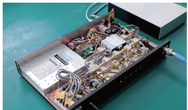
写真. 学生実験用「6ポートコリレータ型VNA」試作機
