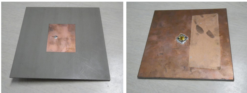
図 2 プローブ給電型方形パッチアンテナの写真
