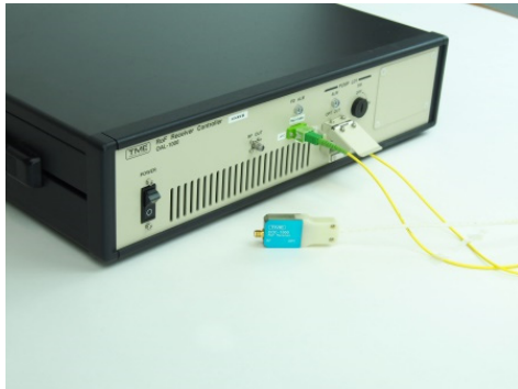
図1 光給電 RoF システム.
