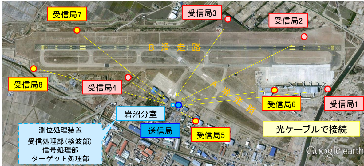
図5. 仙台空港における OCTPASS マルチラレーションの受信局配置
