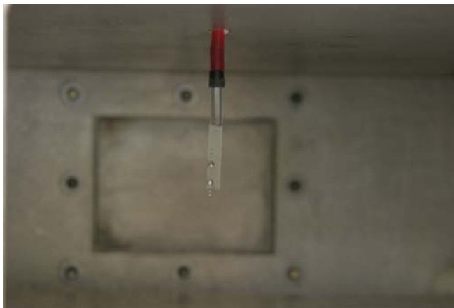
図 3. TEM セル内部に配置された電界プローブ
