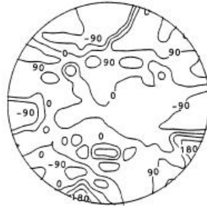
図3 主反射鏡開口面の位相分布 (deg)
