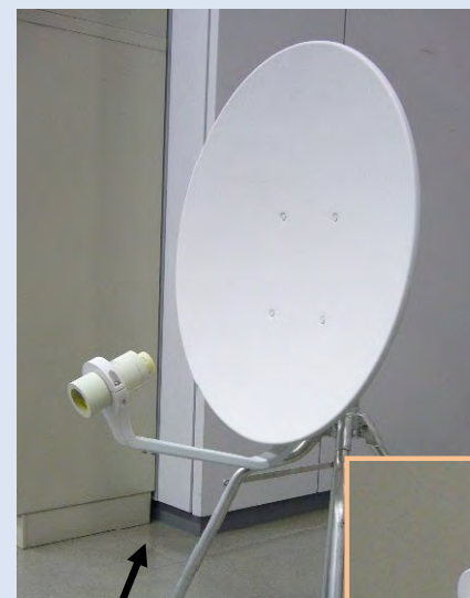
21GHz帯 パラボラアンテナ (開口径45cm)
