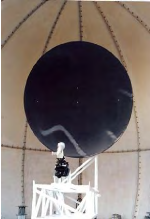
鏡面修整アンテナ (レドームに收容して測定している様子) NEC製 1991年(平成3)
