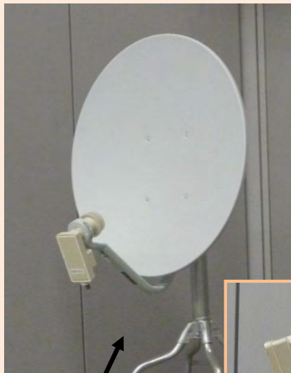
12GHz帯 パラボラアンテナ (開口径45cm)
