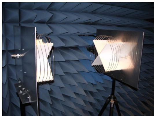
図 13: 試作した接地型アンテナ
