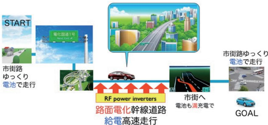
図1 電化道路電気自動車 EVER の基本コンセプト
