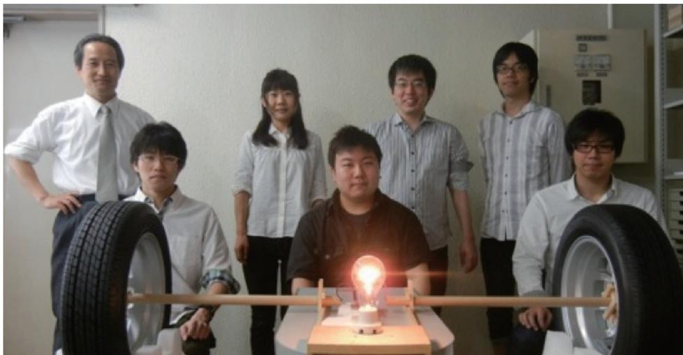
図7 路面下のアルミ電極板から左右のタイヤを介して車軸間へエネルギーが伝わり60W白熱電球が輝いた
