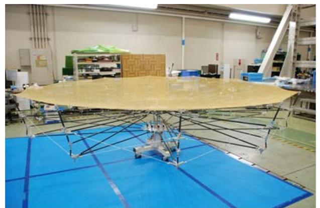
図 12 用いるメッシュ鏡面反射鏡
